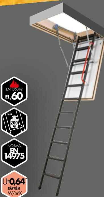
Ugunsdrošās bēniņu kāpnes ar metāla pakāpieniem **LMF 60** ir jaunākās paaudzes produkts, kas atbilst augstām ugunsdrošības prasībām, kā arī nodrošina ērtu un drošu nokļūšanu bēniņos. Kāpnes 60 minūtes nodrošina aizsardzību pret ugnis un dūmu nokļūšanu caur bēniņu kāpnēm gan no telpas uz bēniņiem, gan pretējā virzienā (ugunsdrošības klase El<sub>1</sub>/El<sub>2</sub>=60min, EN 13501-2). Kāpnes pieejamas arī telpām ar augstiem griestiem – līdz pat 360 cm.
