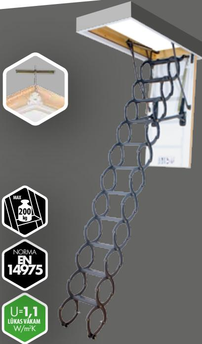
Bēniņu kāpnes **LSZ** ir sabidāmas šķērveida kāpnes ar balvu, 3,6 cm biezū siltumizolējošu lūkas vāku. Kāpņu lūkas kārba izgatavota no koka un integrēta metāla rāmī ar apdares listēm. Pievienojot kāpnēm divus papildus pakāpienus LSS, tās iespējams izmantot telpās ar maksimālo augstumu līdz 330 cm.
