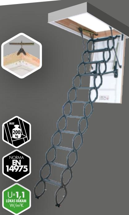
Bēniņu kāpnes **LST** ir sabidāmas šķērveida kāpnes ar balvu, 3,6 cm biezū siltumizolējošu lūkas vāku. Kāpņu lūkas kārba ir izgatavota no koka un tās uzstādīšanai telpas grieost kalpo montāžas kronšteini. Lūkas vāka atvēšanas mehānisms to stabilīti notur jebkurā leņķī un garantē drošu kāpņu izmantošanu. Kāpnes ir nokrāsotas pelēkā krāsā RAL 7022. Pievienojot kāpnēm divus papildus pakāpienus LSS, tās iespējams izmantot telpās ar maksimālo augstumu līdz 330 cm.
