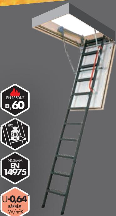
Ugunsdrošās bēniņu kāpnes ar metāla pakāpieniem **LMF 60** ir jaunākās paaudzes produkts, kas atbilst augstām ugunsdrošības prasībām, kā arī nodrošina ērtu un drošu nokļūšanu bēniņos. Kāpnes 60 minūtes nodrošina aizsardzību pret uguns un dūmu nokļūšanu caur bēniņu kāpnēm gan no telpas uz bēniņiem, gan pretējā virzienā (ugunsdrošības klase EI<sub>1</sub>/EI<sub>2</sub> =60min, EN 13501-2). Kāpnes pieejamas arī telpām ar augstiem grieziem – līdz pat 360 cm.
