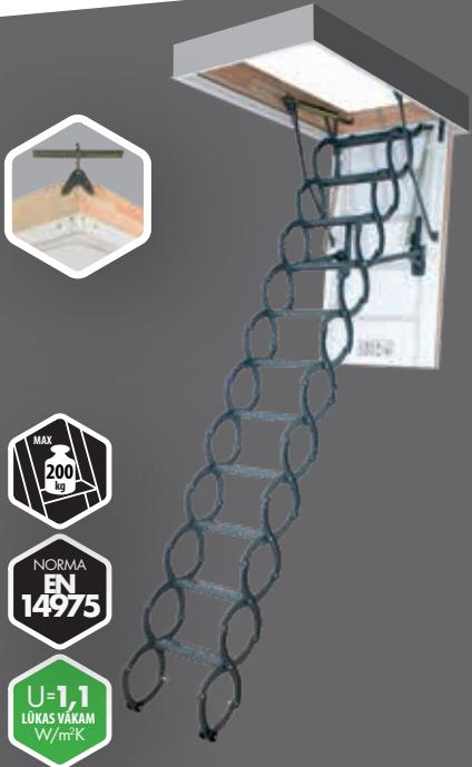
Bēniņu kāpnes **LST** ir sabīdāmas šķērveida kāpnes ar balto, 3,6 cm biezum izolējošu lūkas vāku. Kāpņu lūkas kārba ir izgatavota no koka un tās uzstādišanai telpas grieost kalpo montāžas kronšteini. Lūkas vāka atvēšanas mehānisms to stabilizē notur jebkurā leņķī un garantē drošu kāpņu izmantošanu. Kāpnes ir nokrāsotas pelēkā krāsā RAL 7022. Pievienojot kāpnēm divus papildus pakāpienus LSS, tās iespējams izmantot telpās ar maksimālo augstumu līdz 330 cm.
