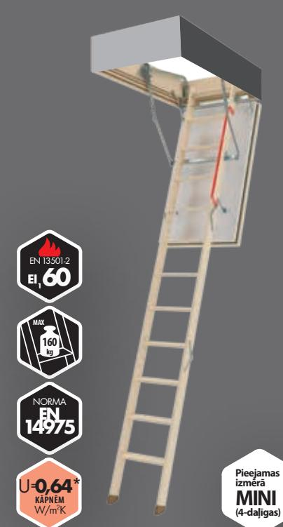
Bēniņu kāpnes **LWF 60** ir jaunās paaudzes ugunsdrošas bēniņu kāpnes, kuras apvieno augstu ugunsdrošību ar ērtu un drošu nokļūšanu bēniņos. Lūkas vāka konstrukcija un izmantotie materiali nodrošina 60 minūšu aizsardzību pret dūmu un ugums izplatišanos no telpas, kurā ir izcēlies ugunsgrēks  $E_1/E_2 = 60\text{min wg EN 13501-2}$ .
